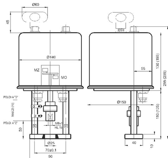
Anschluß für Ventile RV / UV 2x0, RV 2x2, RV 2x4
