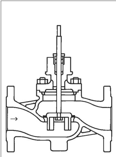
Schnitt durch Ventil mit Lochkegel
