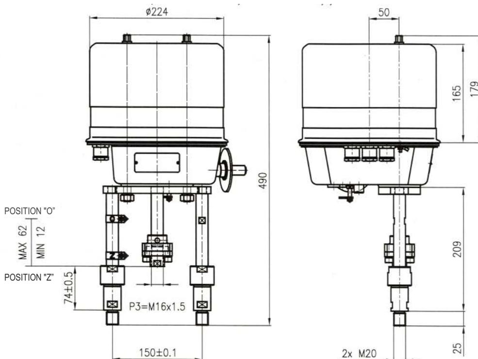
Anschluss P5 - Abstand 150; 4 Säulen M20; Kupplung M20x1,5; Hub 80
