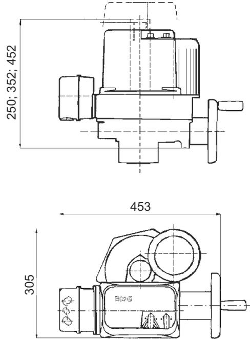
Anschlußform A, Flansch F07
