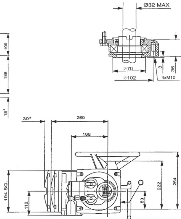
Bei mit \* bezeichneten Abmessungen - Raum zur Deckeldemontage
