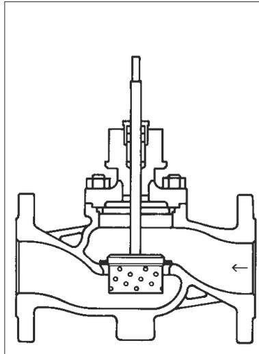
Schnitt durch Ventil mit Mikro-drosselsystem
