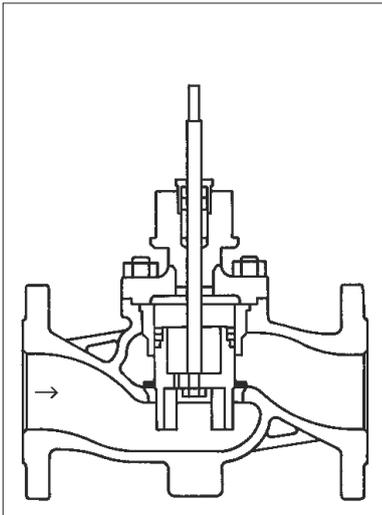
Schnitt durch druckentlastetes Ventil mit Lochkegel
