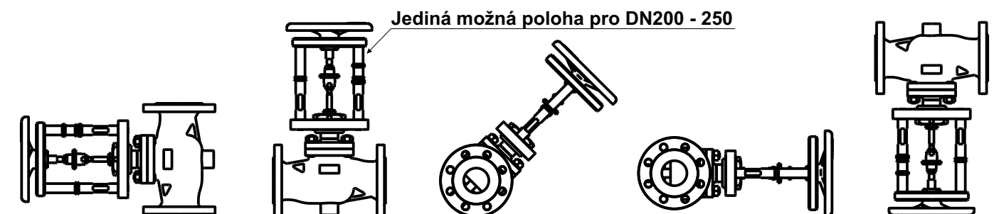
Montážní polohy ventilů s ručním kolem
