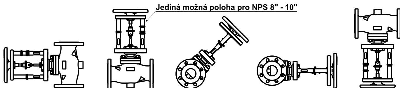
Montážní polohy ventilů s ručním kolem
